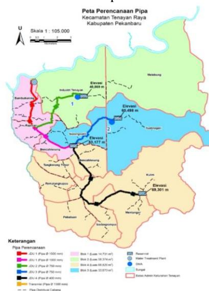
**Gambar-1: Perencanaan Jalur Pipa dan Titik DMA**
